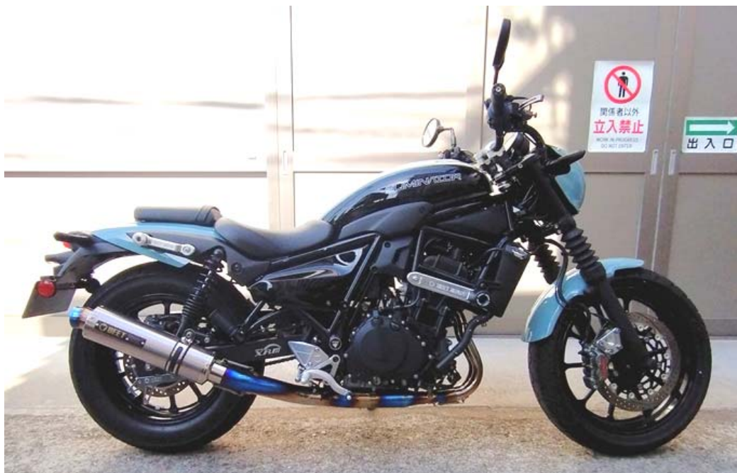
装着マフラーはクリアチタン仕様の試作品です
