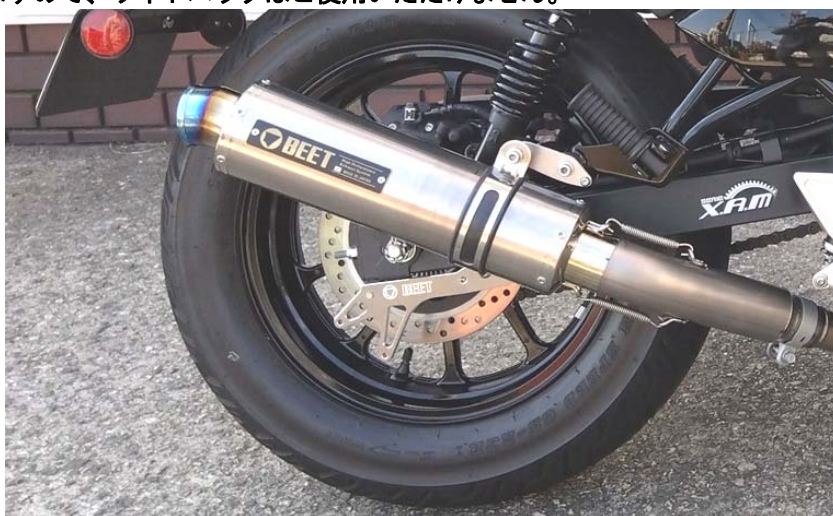
画像のマフラーはクリアチタン仕様の試作品で、研磨及び色付けはしてありません
