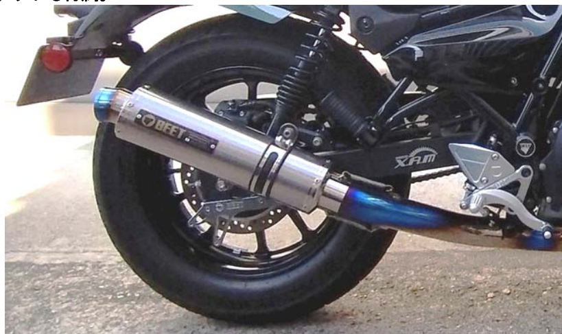
装着マフラーはクリアチタン仕様の試作品です
