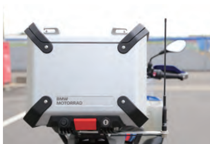
ケースとアンテナのクリアランス 約50mm
