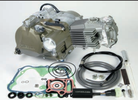
スーパーヘッド4V+Rコンプリートエンジン88cc プライマリー式キックスターターシステムクランクケース スペシャルクラッチ 5ディスク(湿式)/ワイヤー式
