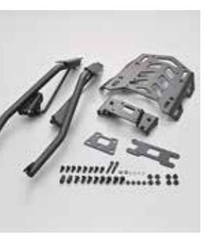
GSX-8S/8R専用リアキャリア。ベース込み重量3.0kg以下のGIVIモノロックケース(汎用ベース)が取り付けできます。シートとのラインをできるだけ揃えるため、荷物が積みやすい。弊社製ヘルメットホルダー(48653/49178)の同時装着が可能。
