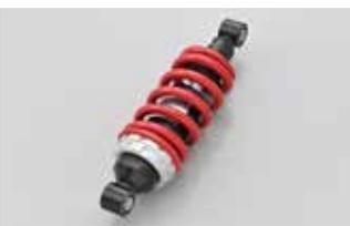
取付長240~245mmに車高調整可能な強化Rショック。ストロークをノーマル以上の28mm確保し乗り心地も確保。オイルダンパー式リアショック、スプリングプリロード無段階調整式、減衰力が効き、コーナーリングが安定する。サイドスタンド交換不要。
