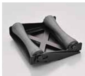
センタースタンドが無いバイクのホイール/チェーンメンテナンスに最適。ローラーをテーパー形状にすることで、タイヤがズレにくいメンテナンスが簡単。ローラー位置を極力低くし、スロープの角度を緩やかにすることで、タイヤの乗り上げが楽になりました。ローラーにはベアリングを内蔵することでタイヤをスムーズに回転できます。タイヤサイズ:10~19インチまで使用可能。使用しない時はスロープを折りたんでコンパクトに収納できます。
