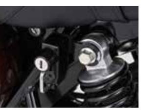
外付けヘルメットホルダーが純正採用されていない車両にボルトオンでヘルメットホルダーが取付可能。
