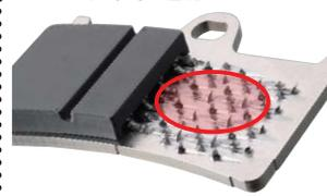
ライニング材とバックプレートの結合面にフック状のマトリクス(NRSフック)採用により接着剤不要の結合を可能にし剥離や鳴きを防ぐsbsの業界唯一の技術です。
