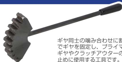
ギヤ同士の噛み合わせに割り込ませる事でギヤを固定し、フライマリードライブギヤやクラッチアウターの脱着時の回り止めに使用する工具です。
