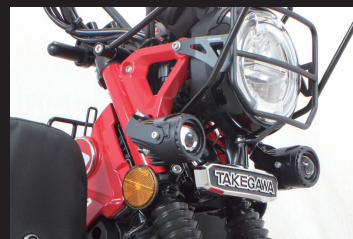
装着写真(取付け位置:Bタイプ) レッグバンパーキットとの同時装着
