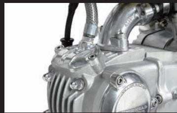
スーパーヘッド4V+R用タペットブリーザーキャップ
