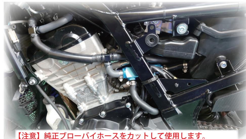
**【注意】 純正ブローパイプをカットして使用します。**
