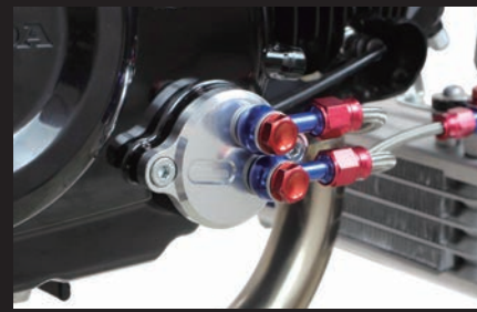
装着写真(オイル取り出し口)
