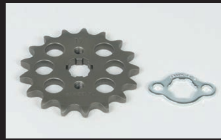
ドライブスプロケット17T(スチール製)
