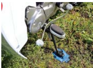
ランタン型のコースターがしっかりと 支えてくれ、陥没を防いでくれます
