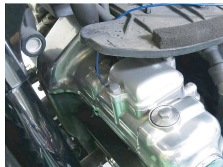
配線の接続先は、インジェクターカブラーハーネスとシリンダーヘッドボルト
