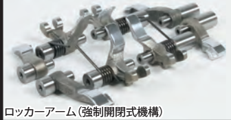
ロッカーアーム(強制開閉式機構)
