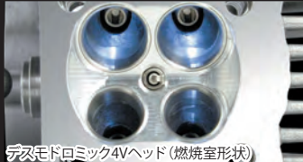
デスモドロミック4Vヘッド(燃焼室形状)
