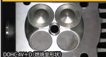
DOHC4V+D(燃焼室形状)
