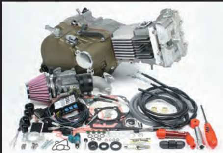
DOHC4V+D コンプリートエンジン124cc プライマリー式キックスターターシステムクランクケース スペシャルクラッチ 5ディスク(湿式)/ワイヤー式
