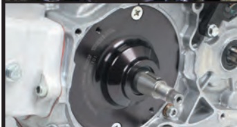
ベアリング内蔵オイルセパレーター
